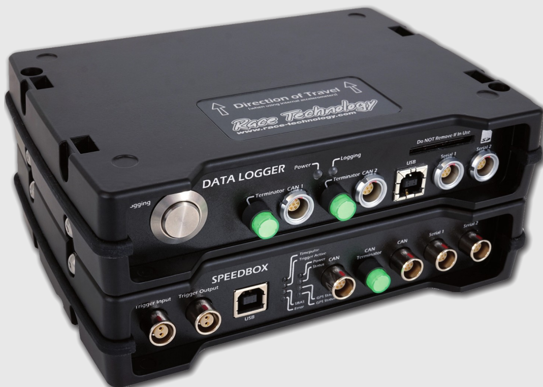
▲ SPEEDBOX MINI et Data Logger modifiés. Connecteurs Lemo avec broches spécifiques et boutons de terminaison CAN.
