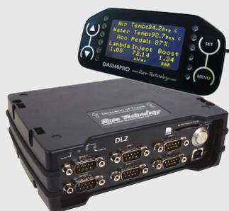
Ces centrales inertielles disposent de sorties CAN, USB et RS232, afin d'étendre leur mode d'utilisation et les intégrer dans une chaîne existante ou en cour de réalisation, avec une flexibilité et une facilité de mise en œuvre remarquables. La RS232 sera privilégiée pour une
