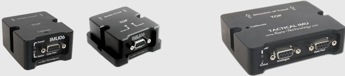
L'**IMU06 std** (*Unité de Mesure Inertielles*) est une mini centrale inertielle compacte à 6 degrés de liberté. Elle mesure les accélérations sur les 3 axes jusqu'à 10g et les vitesses angulaires jusqu'à 300°/s. Elle est disponible en version étanche sous la référence **IMU06-WP**.
